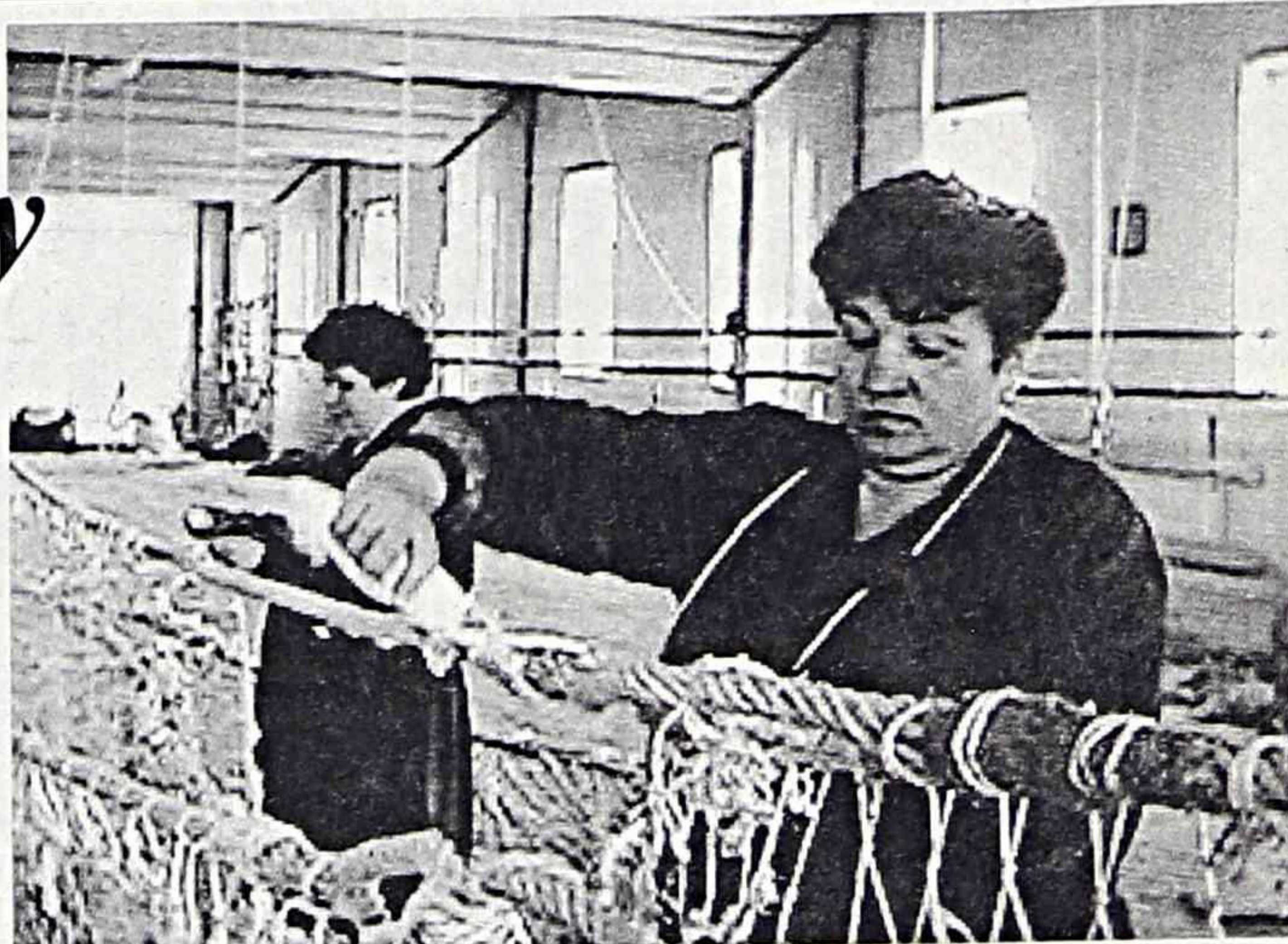
НА СНИМКЕ: сетевязальщицы во время посадки верхней подборы на трал № 59. На переднем плане - Татьяна Якимова, отработавшая на фабрике орудий лова рыбоколхоза "Тихий океан" 23 года, за ней - Раиса Торбокова, посвятившая изготовлению сетей 27 лет. Фото автора.
